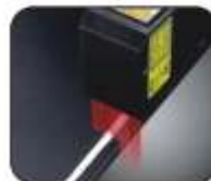
Inspeção do posicionamento e quantidade de selante
