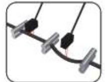
Controle de loop de extrusão de borracha
